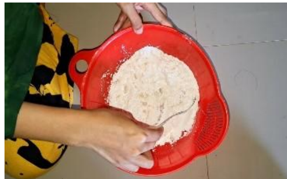
Gambar 6. Tahap pencampuran ampas tebu dan tepung tapioka
